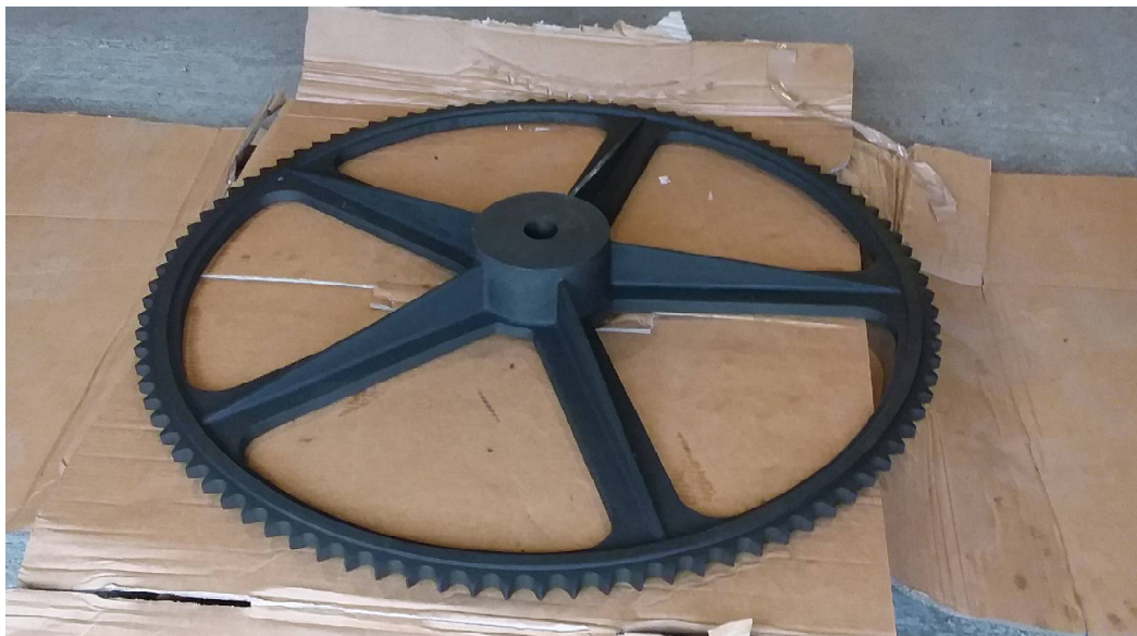
Roue en fonte diamètre 1200mm, 95 dents
